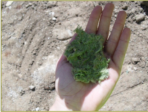
Capa protectora a la que da lugar el tratamiento una vez que se ha secado el hidro-mulch
