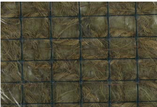
Foto 3- Manta orgánica tridimensional tipo Bonterra K3D . Cara vista y reverso.
